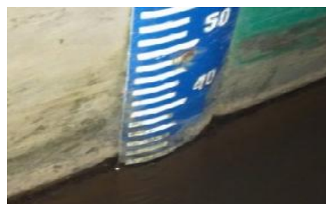
Gbr. 13 Pembacaan Ketinggian Air Menggunakan Peil Scale.
