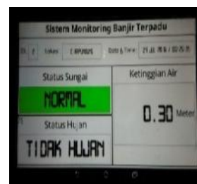
Gbr. 4 Pembacaan Ketinggian Air Menggunakan Sensor Ketinggian Air.
