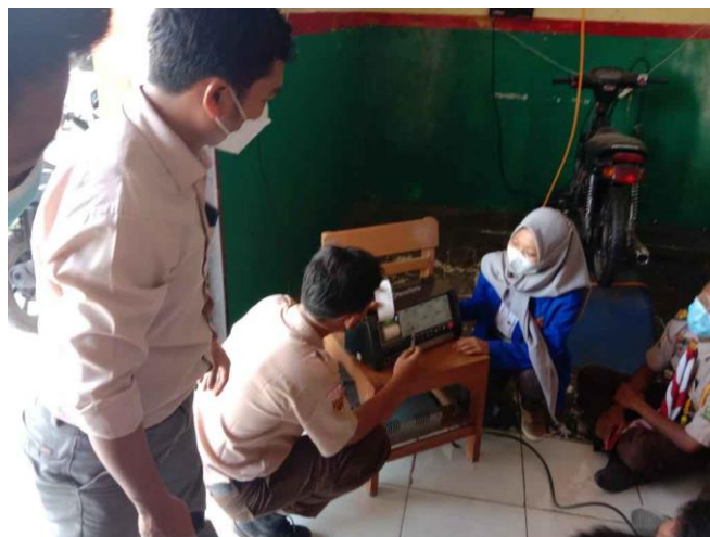
Gambar 8. Peserta PKM melakukan operasi mesin uji emisi gas buang
