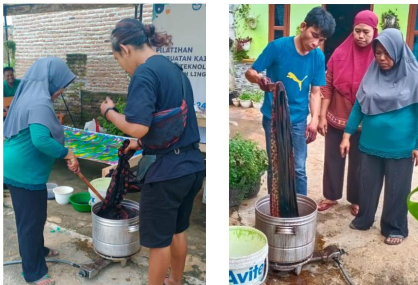
Gambar 8. Proses peluruhan malam (melorod) dengan proses perebusan
