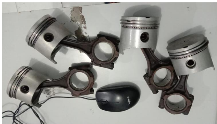
Gambar 2.2 Komponen motor 4 langkah yang dibagikan kepada peserta untuk membantu simulasi
