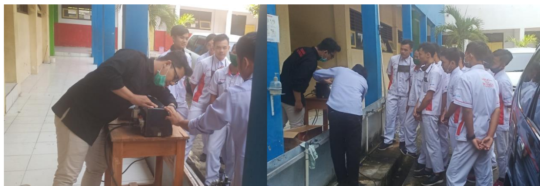
Gambar 4. Praktik mengukur emisi gas buang mesin menggunakan gas analyzer
