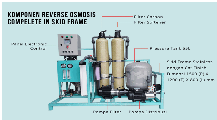
Gambar 8 Komponen Mesin RO
