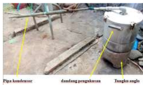
Gambar 2 Rangkaian destilasi uap.
