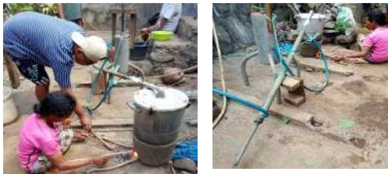
Gambar 4 Rangkaian proses destilasi uap minyak kayu putih
