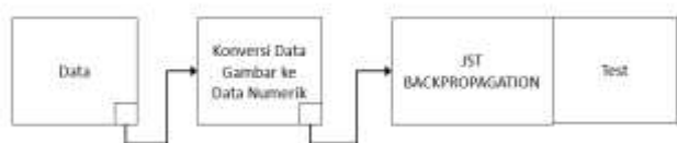
Gbr 3. Model neural network backpropagation dengan konversi data gambar
