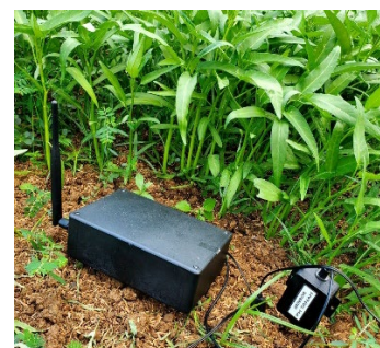
Gbr 7. Implementasi Transmitter sensor tanah pada kebun
