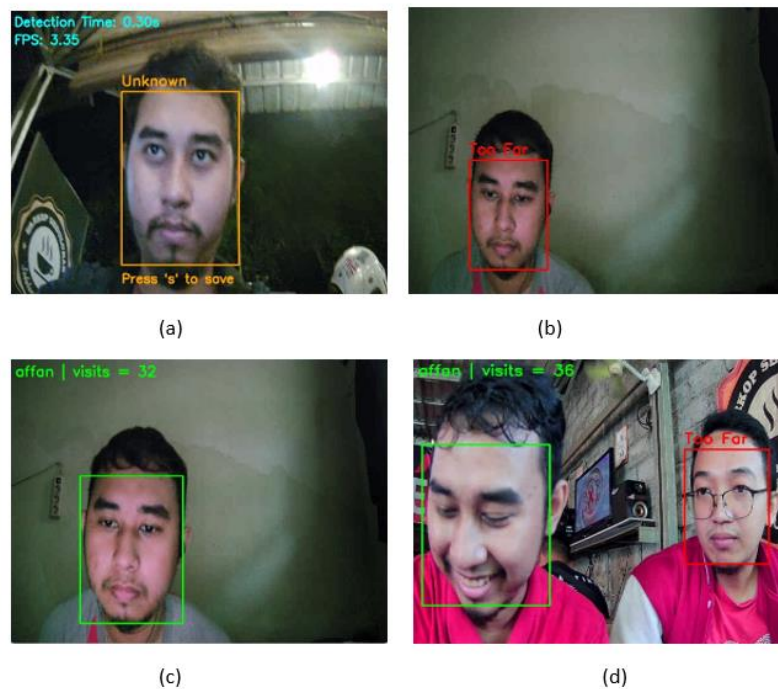
Gambar 12. pengujian sistem dengan deteksi foto wajah (a) belum terdaftar (b) terdaftar dan diluar batas deteksi (c) terdaftar dan dalam batas deteksi , dan (d) pengujian pada dua wajah dengan jarak berbeda
