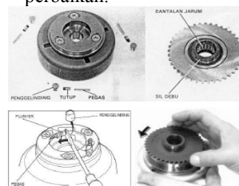
Gambar 19. Pemeriksaan mekanisme kopling satu arah (Beny Setya Nugraha, 2005)
