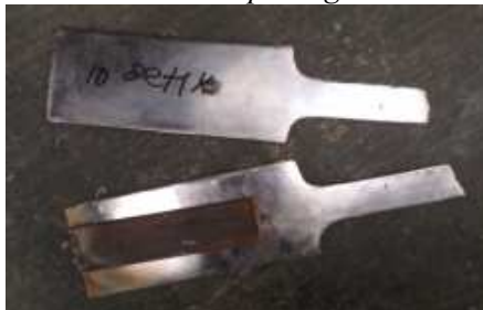
Gambar 7. Gambar 4 Pengujian tarik dengan variasi waktu electroplating 10 detik
