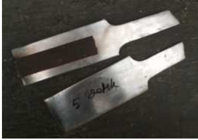
Gambar 6. Pengujian tarik dengan variasi waktu electroplating 5 detik
