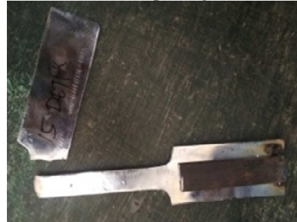
Gambar 8. Pengujian tarik dengan variasi waktu electroplating 15 detik
