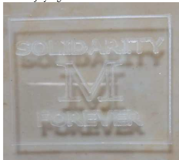
Gambar 7. Hasil Pemakanan Spindle 1000 Rpm Pada Akrilik
