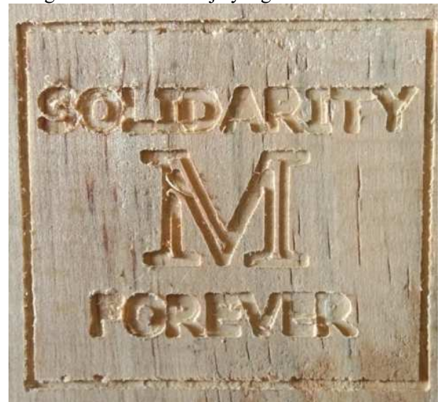
Gambar 11. Hasil Pemakanan Spindle 1000 Rpm Pada KayuSengon
