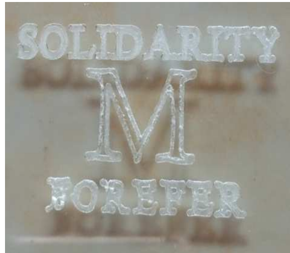
Gambar 5. Hasil Pemakanan Spindle 800 Rpm Pada Akrilik
