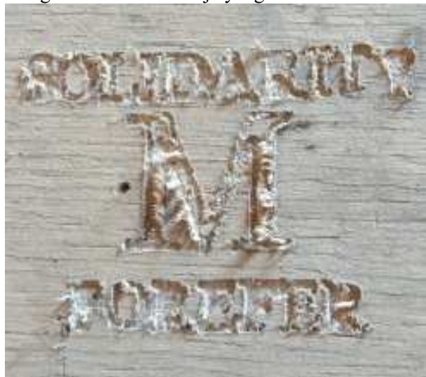
Gambar 9. Hasil Pemakanan Spindle 800 Rpm Pada KayuSengon
