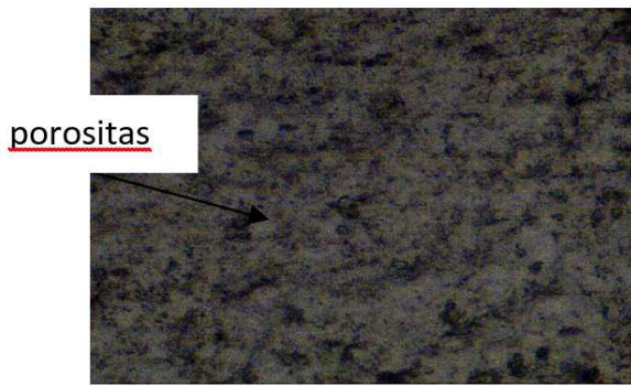
Gambar 6. Hasil Foto Mikro Proses Milling 1100 rpm dengan Pembesaran 500X
