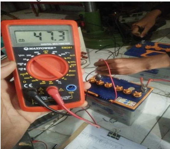
Gambar 5. Mengukur Voltase Awal 4 Baterai Dirangkai Seri
