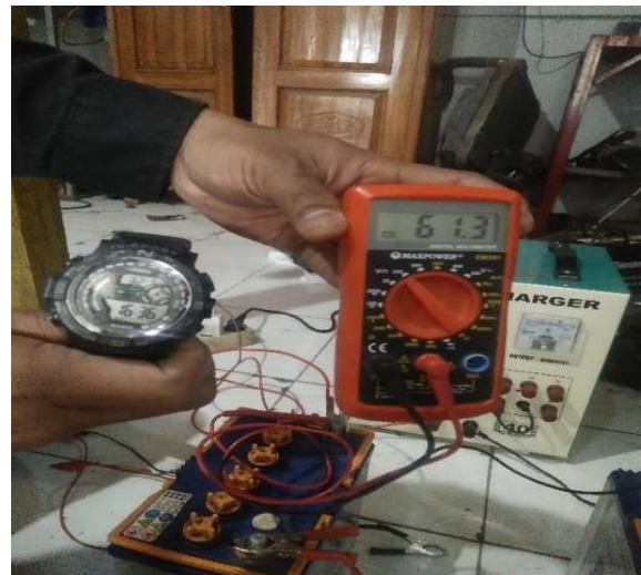
Gambar 7. Mengukur Voltase dan Ampere Pengisian
