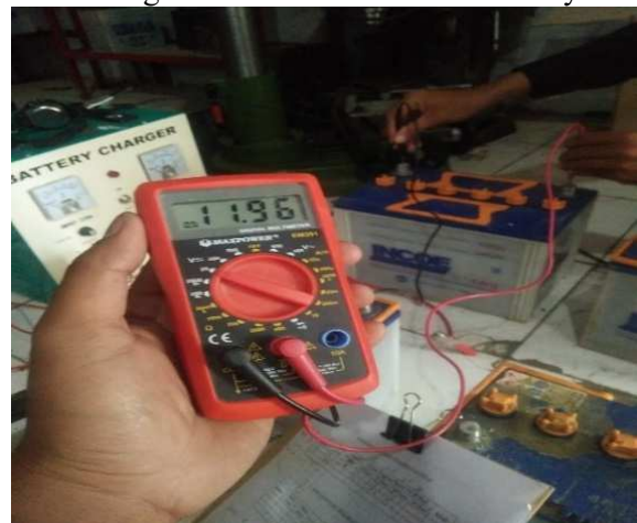
Gambar 3. Mengukur Voltase Awal Tiap Baterai
