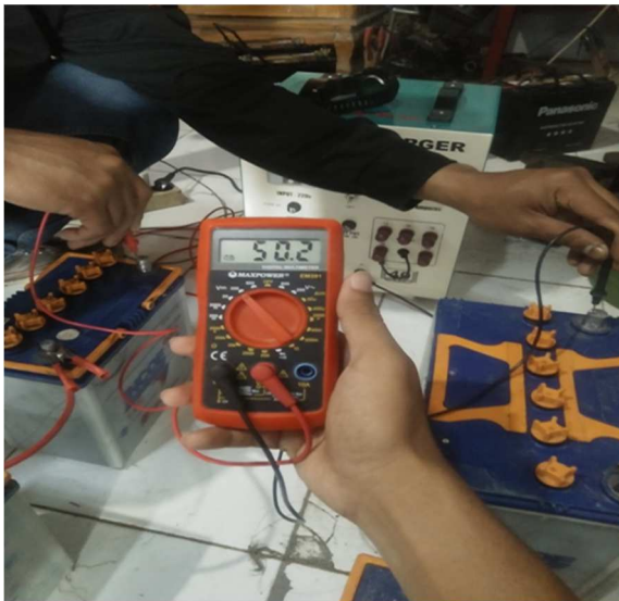
Gambar 8. Mengukur Voltase Akhir 4 Baterai yang Dirangkai Seri
