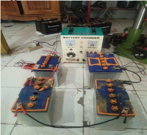
Gambar 4. Rangkaian Seri 4 Baterai
