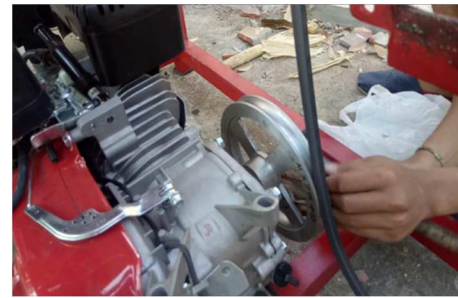
Gambar 2. Pemasangan Pulley diameter 178 mm
