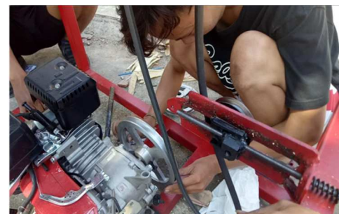
Gambar 3. Pemasangan Pulley diameter 203 mm
