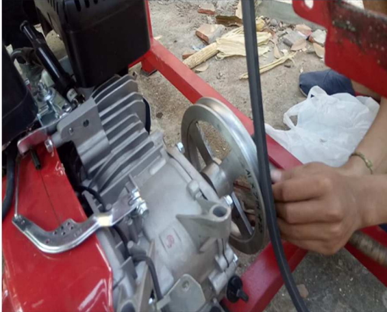
Gambar 3. Pemasangan Pulley D = 178 mm
