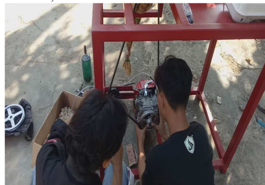
Gambar 2. Pemasangan pulley D = 152 mm
