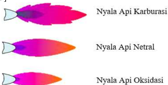
Gambar 1. Jenis Nyala Api pada oxy-acetylene
