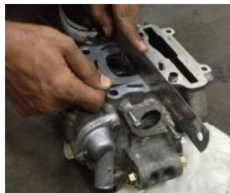
Gambar 2. Pengukuran Kerataan Pada Cylinder Head
