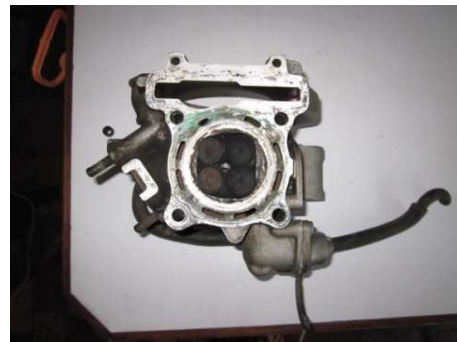
Gambar 1. Endapan Karbon Pada Cylinder Head
