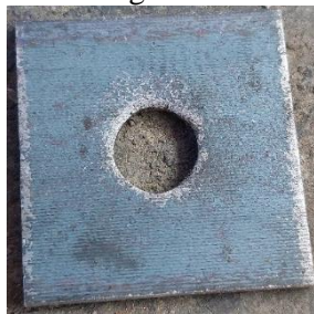
Gambar 2. Ring plat kapal 45x45x0,3 mm
