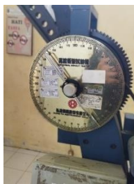
Gambar 15 Proses Menaikan Godam Dengan Posisi Jarum 40°
