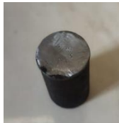
Gambar 11 Hasil Setelah Pengujian Kekerasan Material SS 400
