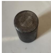
Gambar 12 Hasil Setelah Pengujian Kekerasan Material S 45.C
