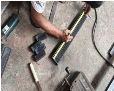
Gambar 3. pengukuran sumbu tengah besi
