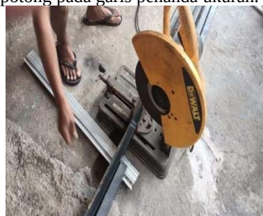
Gambar 2. Pemotongan besi menggunakangerinda duduk
