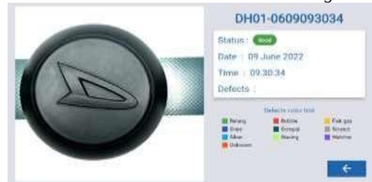
Gambar 4. Hasil Inspeksi Otomatis Part OK
