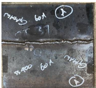
Gambar 16 Hasil Pengelasan 60A
