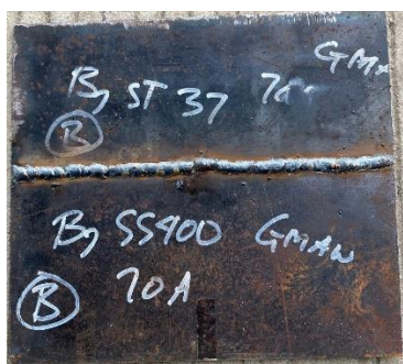
Gambar 17 Hasil Pengelasan 70A
