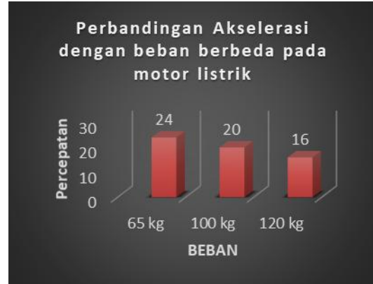
Gambar 1. Perbandingan Akslerasi dengan Beban Berbeda pada Motor Listrik
