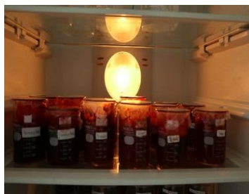
Gambar 2. Uji Stabilitas Pada Suhu Kulkas
