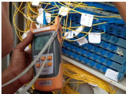
Gbr.5 redaman pada splitter patch cord
