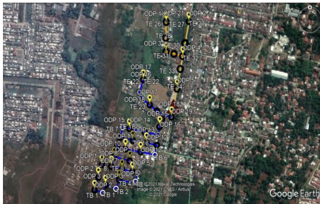
Gambar. 2 Desain jaringan FTTH pada BTR blok O Bekasi dengan dua distribusi.
