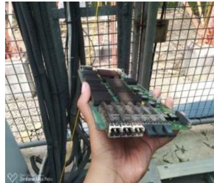
Gambar. 18 Pencabutan modul WBBP yang rusak dari slot BBU.
