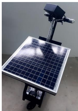
Gambar 4. 3 Panel Surya Kondisi Terbuka
