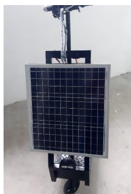
Gambar 4. 4 Panel Surya Kondisi Tertutup
