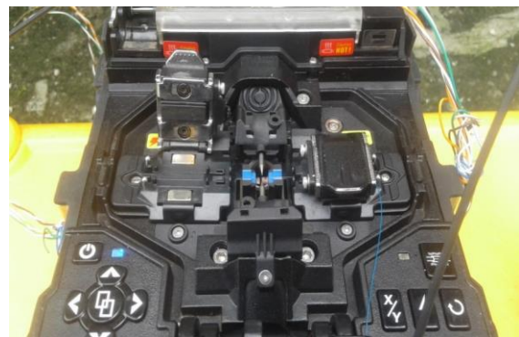
Gambar. 9 Proses penyambungan core serat optik.
