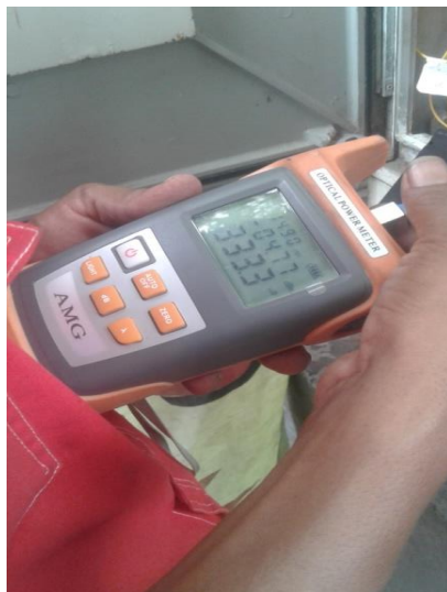
Gambar. 6 Mengukur level daya ODC dengan OPM.
