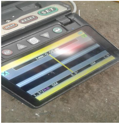
Gambar. 10 Hasil display layar penyambungan core serat optik.
