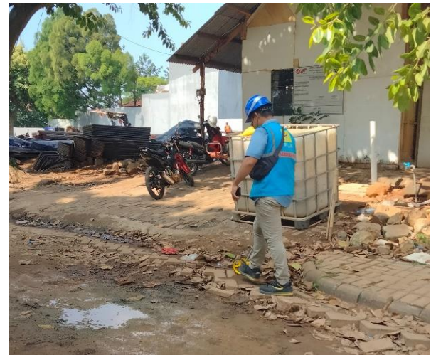
Gambar. 5 Pengukuran panjang kabel menggunakan Measuring Wheel
