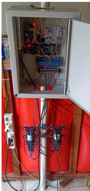
Gambar 9. Penempatan Aktuator Pada Tiang
