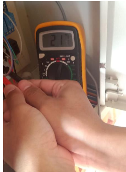
Gambar 26. Pengukuran tegangan pada aktuator yang membutuhkan tegangan AC
