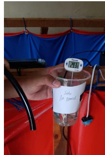
Gambar 16. Percobaan Melihat Respon Sistem Terhadap Perubahan Suhu Air Menggunakan Air Normal
