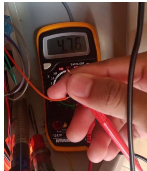
Gambar 25. Relay ketika diberikan logika high
