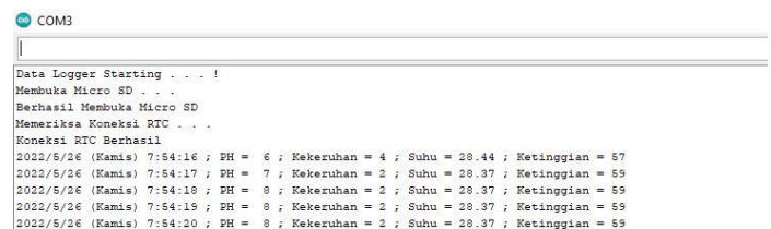
Gambar 22. Pengujian Melihat Serial Monitor Untuk Mengamati Respon Sistem Data logger Saat Proses Pencatatan Data
