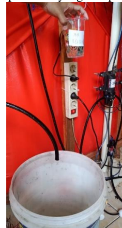
Gambar 13. Percobaan Melihat Respon Sistem Terhadap Perubahan Kekeruhan Air Menggunakan Air Bersih
