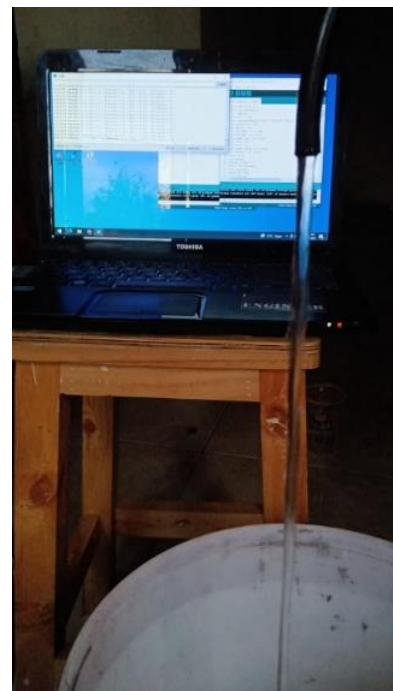
Gambar 20. Percobaan Pengamatan Respon Sistem Terhadap Perubahan Ketinggian Air Saat Nilai Ketinggian Air Melebihi Nilai Standar Yang Telah Ditentukan.
