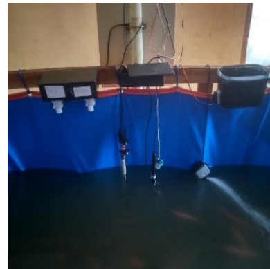
Gambar 10. Penempatan Sensor dan Aktuator Pada Kolam
