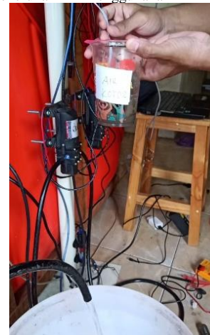
Gambar 14. Percobaan Melihat Respon Sistem Terhadap Perubahan Kekeruhan Air Menggunakan Air Kotor
