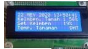
Gambar 8 hasil dari pengukuran kelembapan pada tanah basah
