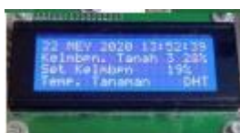
Gambar 7 hasil dari pengukuran sensor pkelembapan tanah lembap
