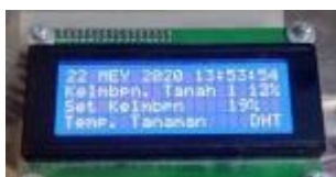
Gambar 6 hasil dari pengukuran kelembapan pada tanah kering
