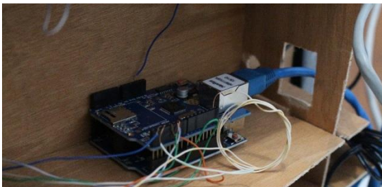
Gambar 4.2 Implementasi Rangkaian pada Arduino dan Ethernet Shield
