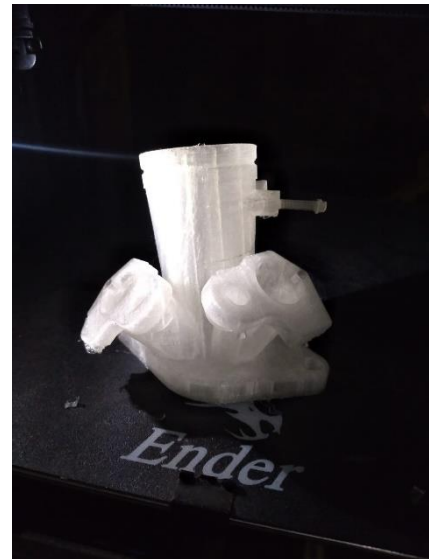
Gambar 18. Project Jadi Setelah Support Dibersihkan
