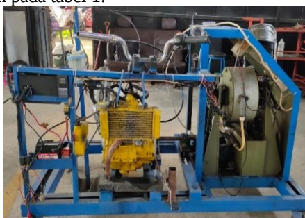
Gambar 1. Mesin bensin EFI 150 cc yang terhubung dengan dynotest.
