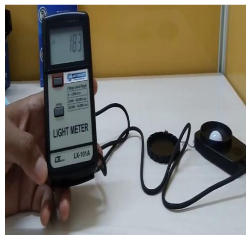
Gbr 2. Alat Ukur Lutron Light Meter LX-101 ALS
