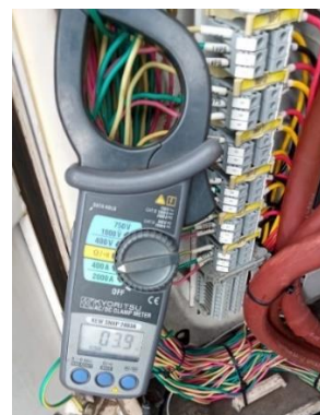
Gambar. 4 Hasil Pengukuran Arus Pump
