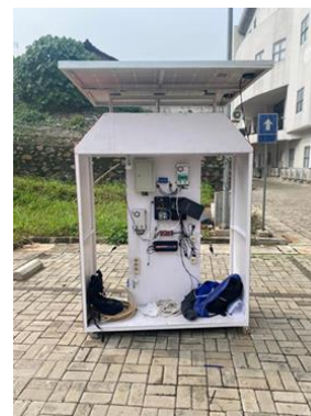
Gambar 3 Prototype SPKL berbasis Pembangkit Listrik Tenaga Surya
