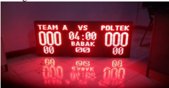
Gambar 4.19. Tampilan Score Board Basket Untuk Pengaturan Waktu Pengurangan 1 Menit m. Tekan START untuk memulai waktu yang sudah diatur
