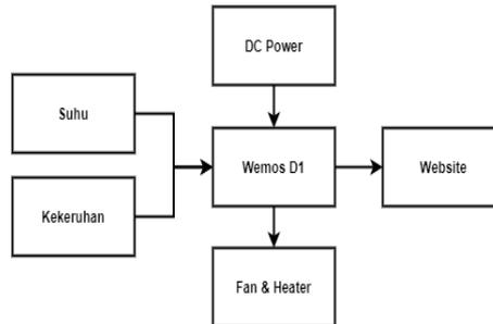
Gambar 2 Diagram Blok
