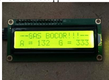
Gambar 7. Display LCD Ketika Mendeteksi Gas Bocor
