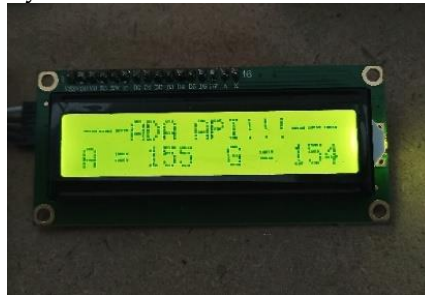
Gambar 5. Display LCD Ketika Mendeteksi Api
