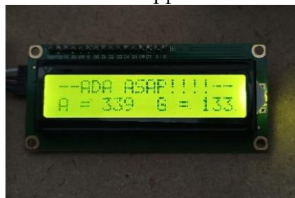
Gambar 6. Display LCD Ketika Mendeteksi Asap
