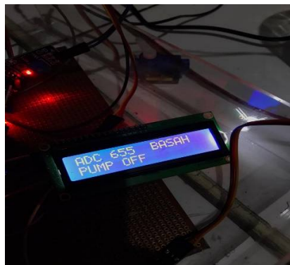
Gambar 8. Tampilan LCD dengan Sensor dalam Keadaan Basah
