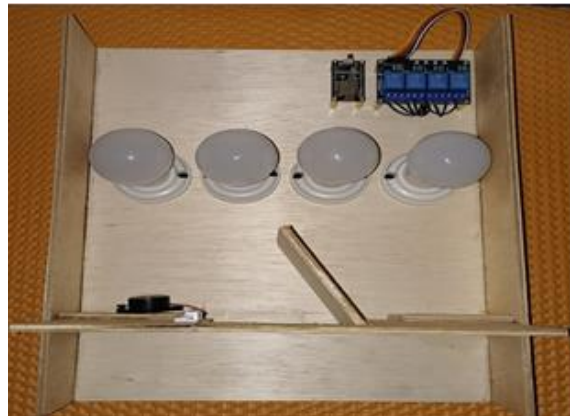
Gambar 6. Tampilan sistem monitoring lampu dan sensor pintu berbasis Telegram
