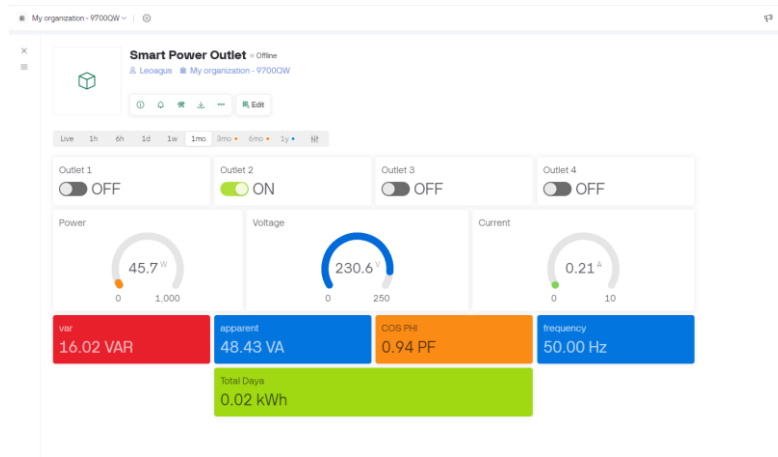
Gambar 9. Hasil Uji Coba Beban Induktif Pada Tampilan Dashboard
