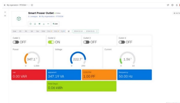
Gambar 11. Hasil Uji Coba Beban Resistif Pada Tampilan Dashboard
