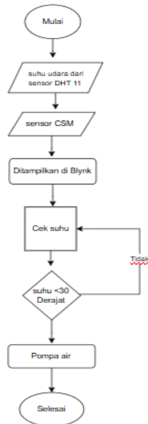
Gambar 4. Flowchart Pengaturan Suhu kelembapan
